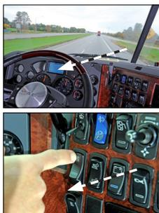
**⚠** La alerta de impacto es la advertencia más grave que emite el sistema Wingman Advanced. Esta alerta indica que es probable que se produzca una colisión con el vehículo detectado delante. El conductor debe actuar de inmediato para evitar potencialmente o disminuir la gravedad de una colisión. La alerta de impacto está lista para alertar al conductor cuando el vehículo se desplaza a más de 24 kph (15 mph).
