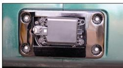
Arriba: ejemplos de sensores del radar.
