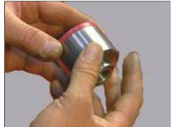
**FIGURE 82 - POSITION DU NOUVEAU CACHE-POUSSIÈRE DANS L'OUTIL DE FIXATION (T7)**
