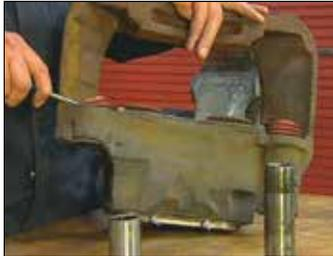
**FIGURE 68 - DÉPOSER LES ANNEAUX DE RETENUE, LES TIGES DE GUIDAGE ET LES CACHE-POUSSIÈRE**
