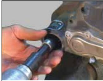
**FIGURE 67 - DÉPOSE DES BOULONS DE L'ÉTRIER**
