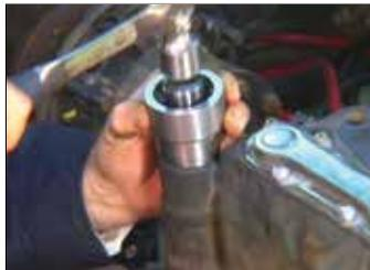
**FIGURE 85 - LES CACHE-POUSSIÈRE DOIVENT ÊTRE COMPLÈTEMENT COMPRIMÉS PENDANT L'INSTALLATION DU CAPUCHON**
