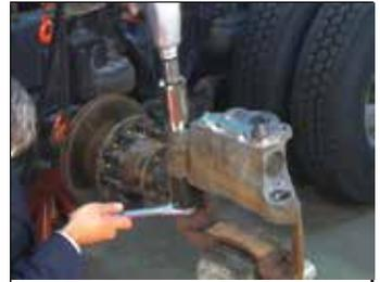
**FIGURE 71 - DÉPOSE DE LA LONGUE TIGE DE GUIDAGE**
