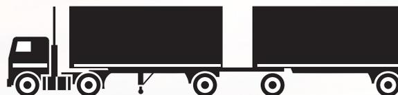
Un véhicule de ligne 4x2 (essieu moteur unique) :
