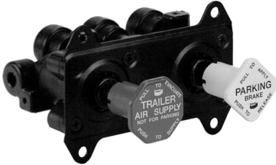
El módulo de control del tablero de instrumentos Bendix® MV-3™ es una válvula de control de empujar-halar, de dos botones, encajada en un solo cuerpo, la cual incluye una válvula de suministro de circuito doble y una válvula de retención. La válvula MV-3™ puede duplicar las funciones de cualquiera de las dos o tres válvulas existentes del sistema empujar-halar y tiene la ventaja de reducir las tuberías.
