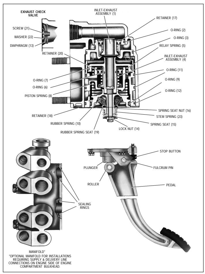
FIGURE 2 - E-7™ DUAL BRAKE VALVE
