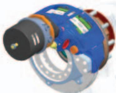
Avec les freins pneumatiques à disque Bendix®, la même taille de frein peut être utilisée sur tous les essieux. Les modèles de freins traditionnels requièrent différents composants sur les essieux avant, moteur ou de la remorque, ce qui augmente le nombre de pièces différentes requises pour assurer l'entretien du système de freinage. S'équiper de freins pneumatiques à disque Bendix signifie moins de pièces à acheter, à stocker et des coûts de gestion de stocks de freins moindres.
