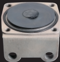
VALVE DE DESSERRAGE RAPIDE E-6 CLONÉE À seulement 450 000 cycles d'endurance : • diaphragme déchiré • fuite de l'air d'alimentation dans l'atmosphère Résultat : fuite d'air importante. Désalignement possible du véhicule. Performances médiocres des freins du véhicule.
